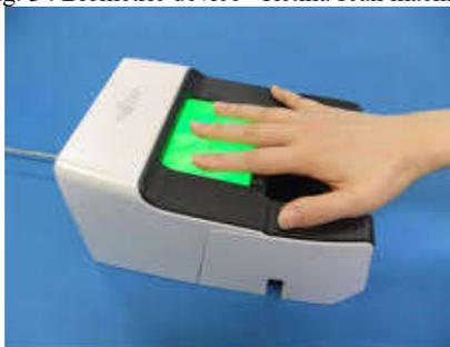
Fig. 4 : Biometric device-Finger Palm print
